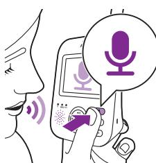
Tlačidlo hlasitého hovoru na rodičovskej jednotke môžete použiť na rozprávanie sa s dieťaťom.
