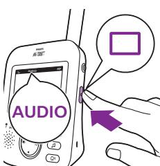
1 Naciśnij przycisk trybu z boku odbiornika, aby włączyć tryb AUDIO.
