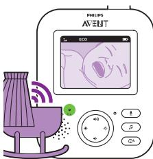
W przypadku wykrycia dźwięku przez nadajnik ekran i dźwięk w odbiorniku są natychmiast włączane. Dźwięki są przekazywane do odbiornika.
