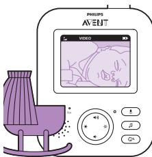
Po włączeniu trybu VIDEO ekran jest cały czas włączony, więc możesz obserwować dziecko. Wszystkie dźwięki są bezpośrednio transmitowane do odbiornika.
